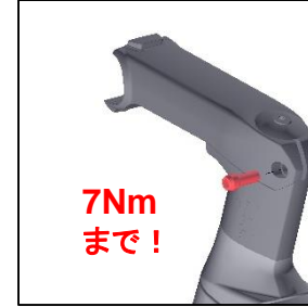
ステム固定ボルトにグリスを塗り、取り付けます
